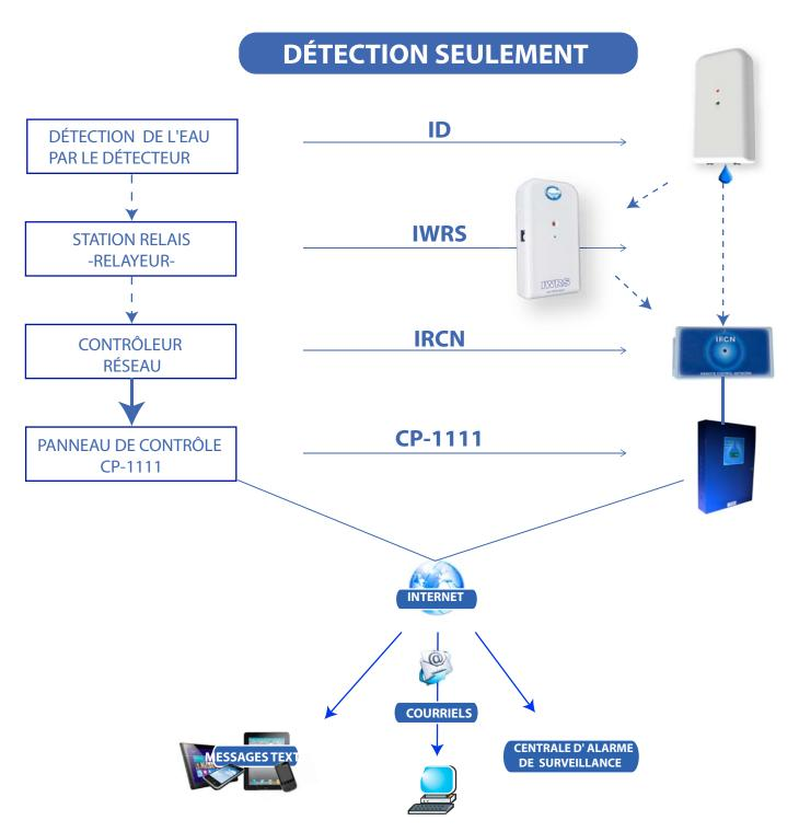
La supervision globale d'un immeuble est assurée par des groupes de détecteurs intelligents sans fil (ID) en communication constante avec leur contrôleur respectif (IRCN). Des relayeurs (IWRS) peuvent être ajoutés au besoin pour une plus grande couverture réseau. Tous les IRCN communiquent à leur tour avec le panneau de contrôle (CP-1111) qui gère ainsi toutes les alarmes (détection, liaison ou autres) en fonction des paramètres établis.
